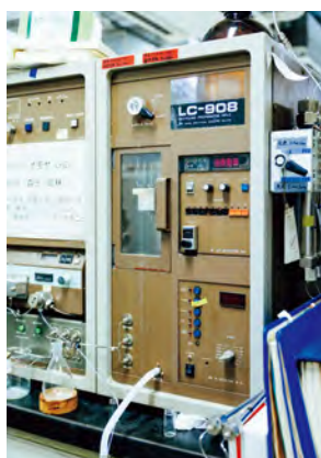
20年以上使っているポリマーを精製する装置。分子量の低いものから高いものまで分けて分析をすると、反応の様子が分かってくる。
