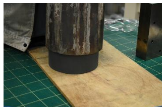
金型に再生材料のペレットを 充填しプレスして成形
