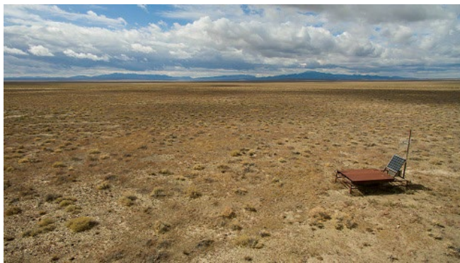
図3：アメリカ ユタに設置されているテレスコープアレイ実験の地表粒子検出器（画像提供：大阪公立大学）
